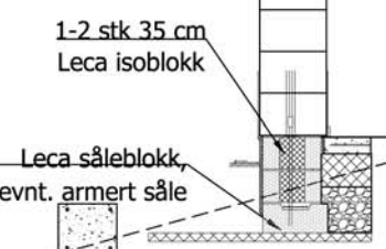
Forslag til fundamenteringsmetode. Grunnens beskaffenhet legges til grunn for valg
